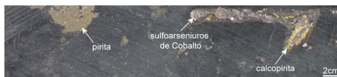
Fig 1: Diseminaciones de sulfarseniuros de cobalto, calcopirita y pirita en pizarra oscura. Muestra tomada del stockwork de Tharsis.
